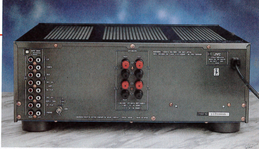
La vista posteriore mette in mostra l'ordinata disposizione dei connettori di ingresso e di uscita con, in alto a sinistra, il minuscolo commutatore per il collegamento «differenziale».
